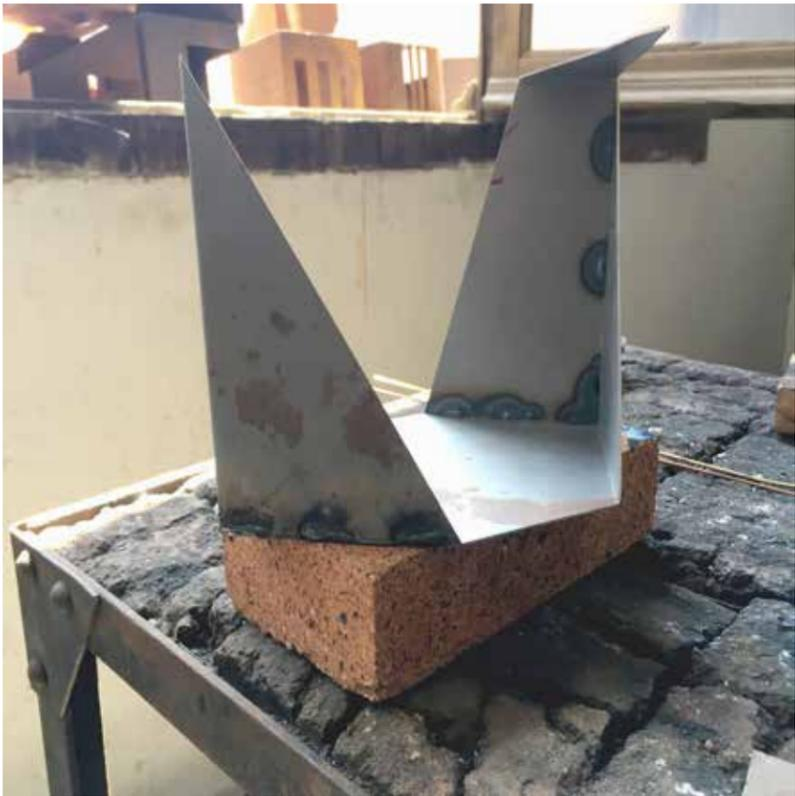
Utilízase limas y radial para pulir las superficies y igualar los puntos de soldadura y cantos.
